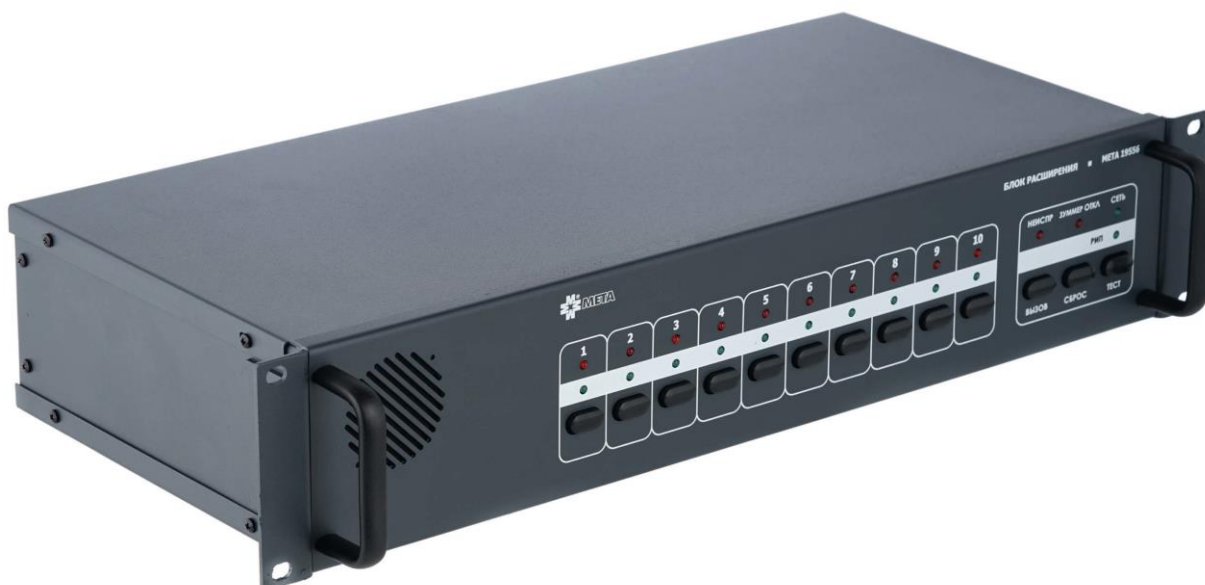
Рисунок 6. Внешний вид блока расширения МЕТА 19556.
